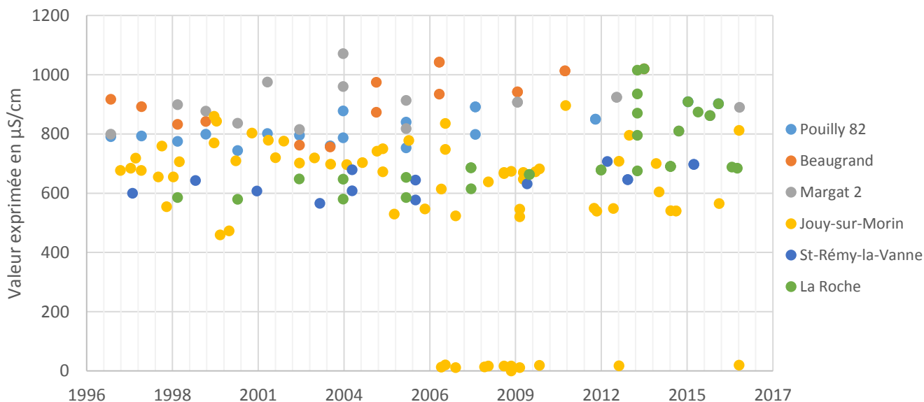
Figure 42 : Evolution de la conductivité des différents ouvrages (ADES, ARS, SNE, Ville de Coulommiers)
