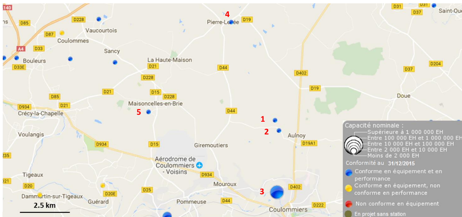
Figure 14 : Installations pour l'assainissement collectif répertoriées sur la zone d'étude (Ministère de l'Environnement)
