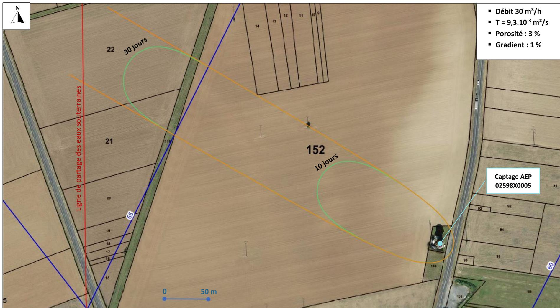
Figure 29 : Zone d’appel et Isochrones estimées par la formule de Wyssling pour un gradient de nappe de 0,5 % et une porosité cinématique de 1 % (d’après logiciel ZAPPEL)
