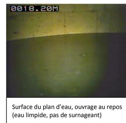
Surface du plan d'eau, ouvrage au repos (eau limpide, pas de surnageant)
