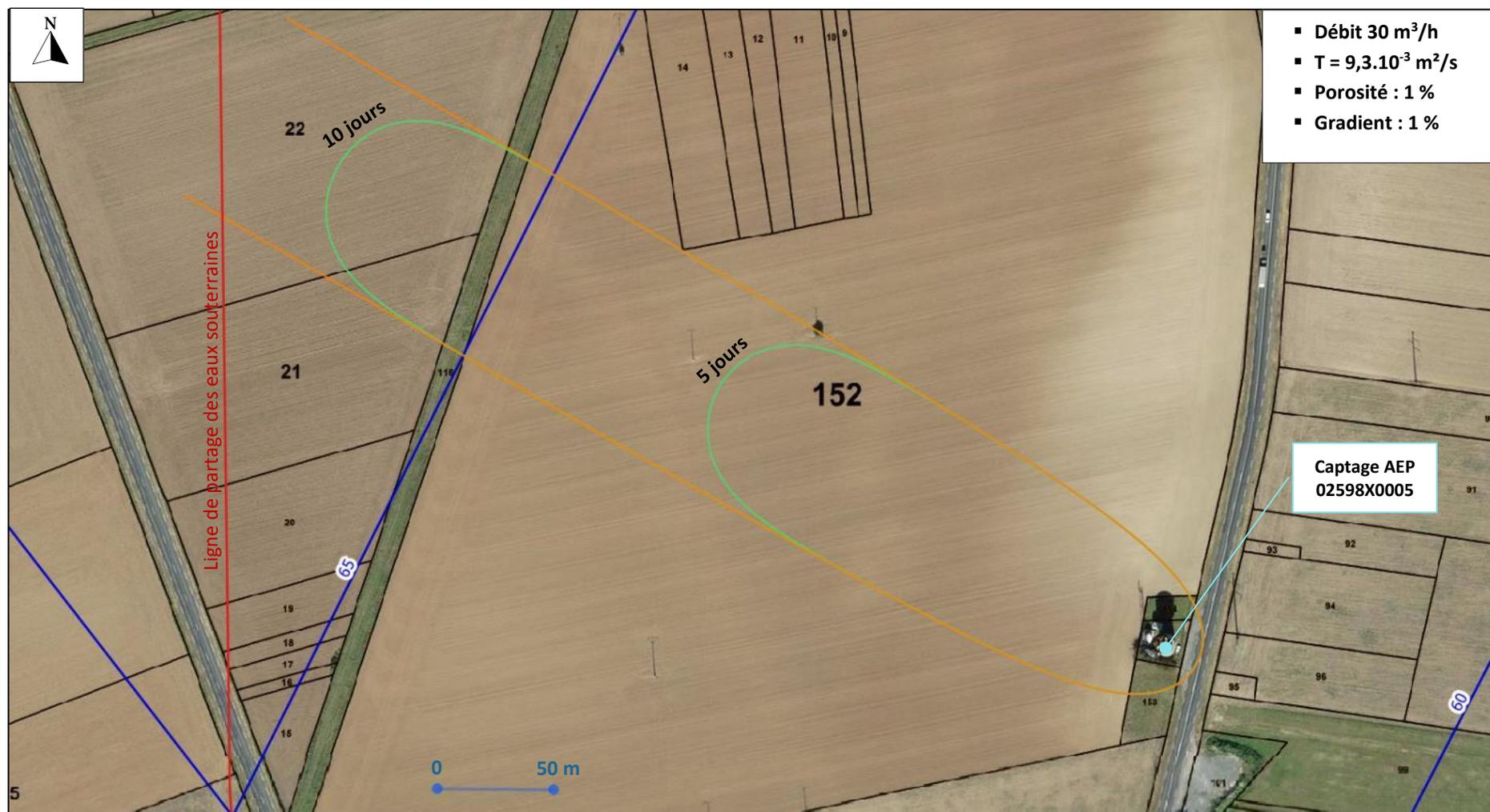
Figure 28 : Zone d'appel et Isochrones estimées par la formule de Wyssling pour un gradient de nappe de 1 % et une porosité cinématique de 3 % (d'après logiciel ZAPPEL)
