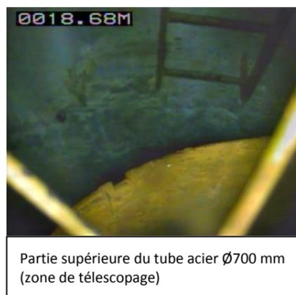
Partie supérieure du tube acier Ø700 mm (zone de télescopage)
