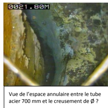
Vue de l'espace annulaire entre le tube acier 700 mm et le creusement de Ø ?
